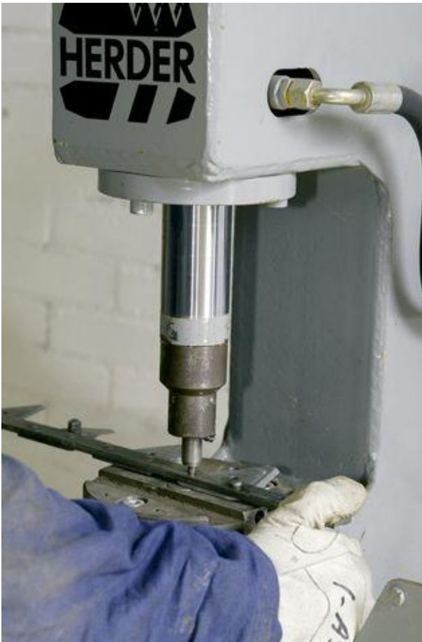
Figuur 10-4: Een hydraulische pers voor het verwijderen en klinken van mesjes
